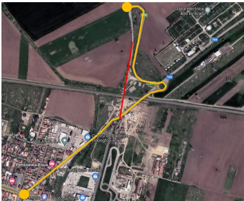
Figura 3.9. Pasaj (—) în execuție peste CF Arad - Deva și traseu provizoriu (—) pe DJ 709 cu trecere la nivel. Sursa: Google Maps.
