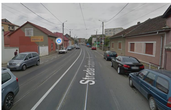
Figura 3.62. Linie de tramvai în carosabil pe Str. Cocorilor fără marcaj de delimitare a benzilor de circulație și vehicule parcate neregular.
