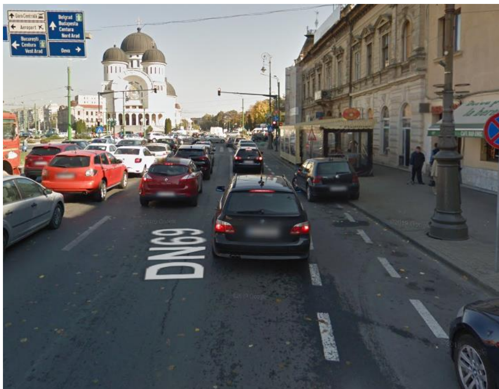
Figura 3.58. Bulevardul Revoluției în zona Piața Podgoria - bandă de circulație sub lățimea normală, pistă de biciclete, terase amplasate pe trotuar, cu strângerea circulației pietonale. Sursa: Google Maps.
