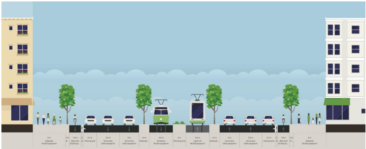
FIGURA 106 SECȚIUNE BULEVARDUL REVOLUȚIEI (SEGMENTUL PRIMĂRIE - TEATRU) - VARIANTA 1
